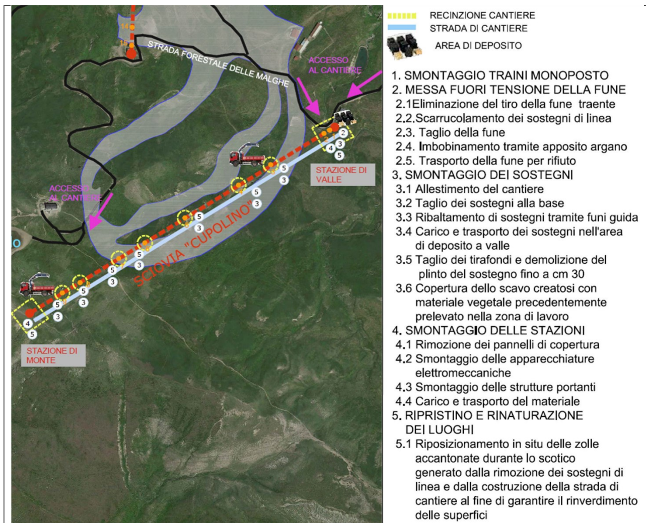
Figura 4 - Cantierizzazione dello smontaggio della sciovina "Cupolino".
