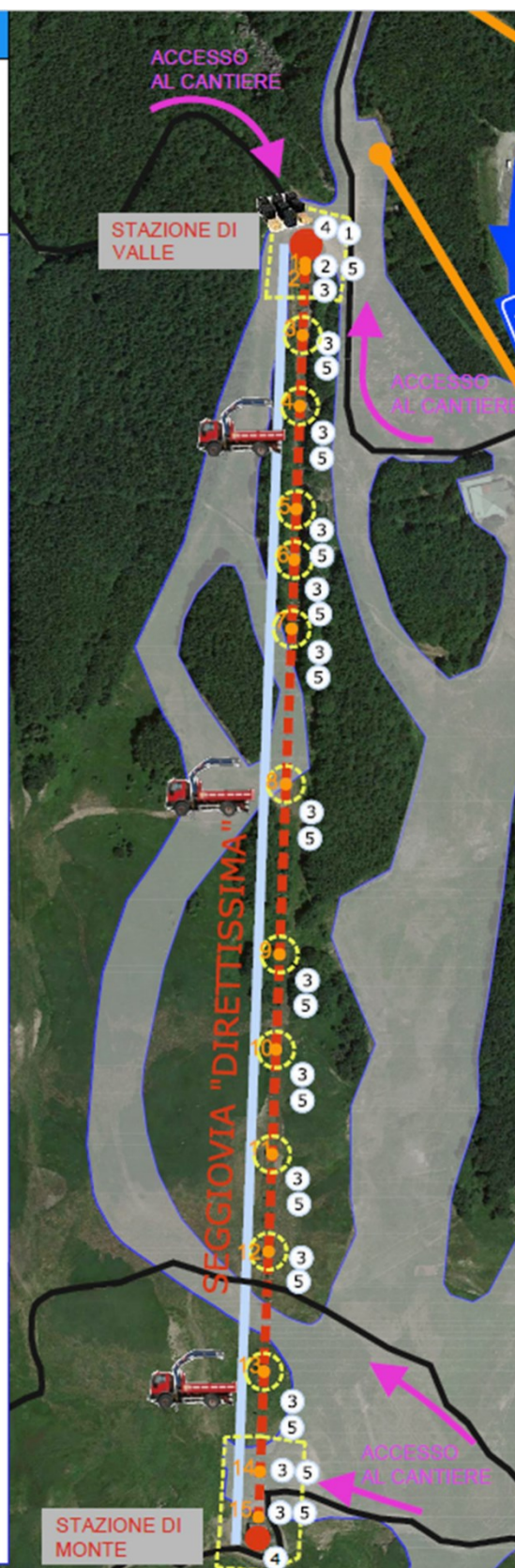
Figura 3 - Cantierizzazione dello smontaggio della seggiovia "Direttissima".
