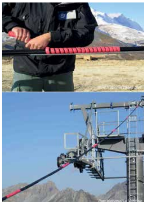
Figura 61 – Dispositivo di segnalazione montato in Francia sul cavo multicoppia delle seggiovie (foto: OGM - Observatoire des Galliformes de Montagne, tratta da Tomasi et al., 2015).
